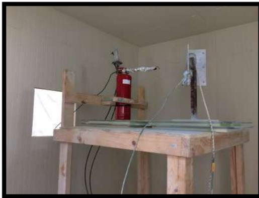
Imagen 10. Extintor montado en banco de ensayo
