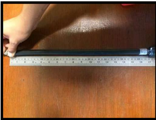
Imagen 16. Verificación dimensional De longitud de manguera.
