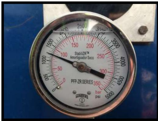
Imagen 20. Dos veces la presión de ensayo
