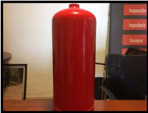
Imagen 3. Cilindro sin hallazgo de oxidación.
