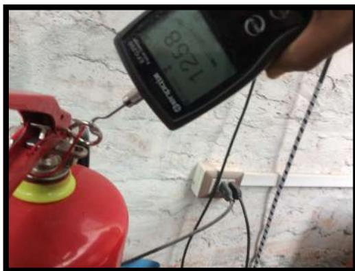
Imagen 14. Aplicación de fuerza con dinamómetro en ángulo de 45°
