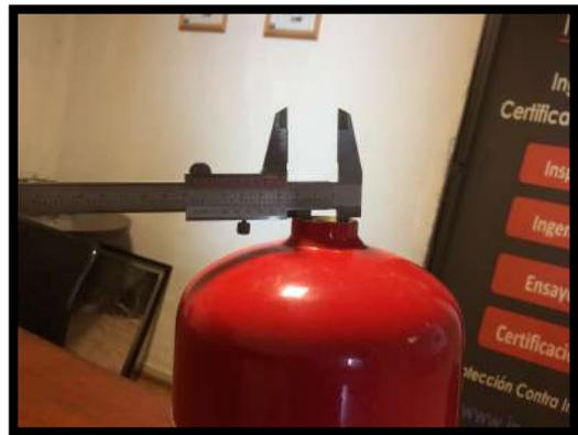
Imagen 17. Verificación diámetro interno de abertura de llenado del cilindro.
