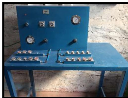
Imagen 23. Equipo para ensayo de impulso de presión, sobre presión y ensayo de para los 1000 ciclos
