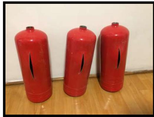
Imagen 21. Ruptura a presión de 101, 9 kg/cm<sup>2</sup>
