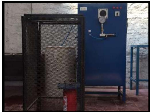
Imagen 19. Prueba hidrostática de Cilindro.
