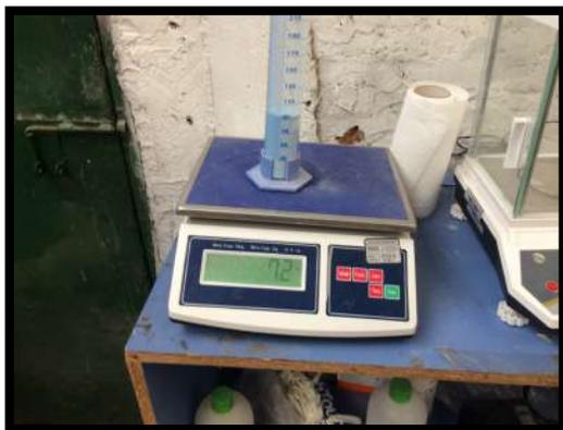
Imagen 24. Ensayo de densidad aparente
